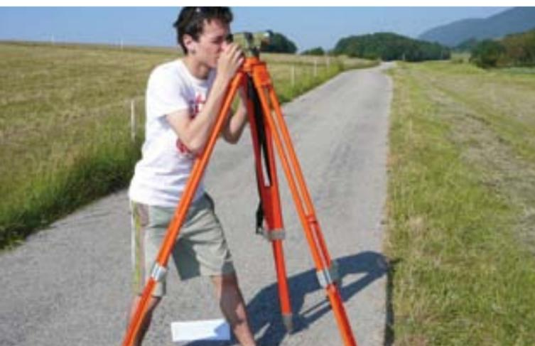
Abbildung 254, Messungen mit dem Theodolit
